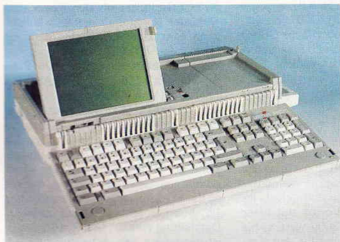
Abb. 2 : Der PPC 512 - Ein portabler MS-DOS-Rechner mit 3,5"-Floppy.
